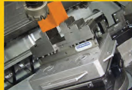
Mechanischer Zentrischspanner MZC auf Palettiertsystem
