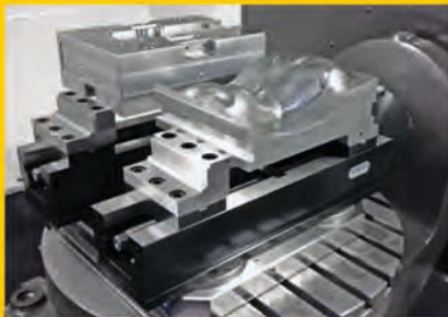
Mechanischer Zentrischspanner MZU auf Nullpunktspannsystem
